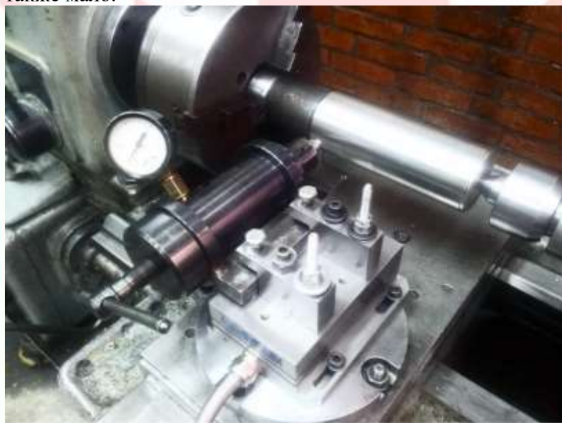
Рис. 1 – Установленная пневматическая оправка
