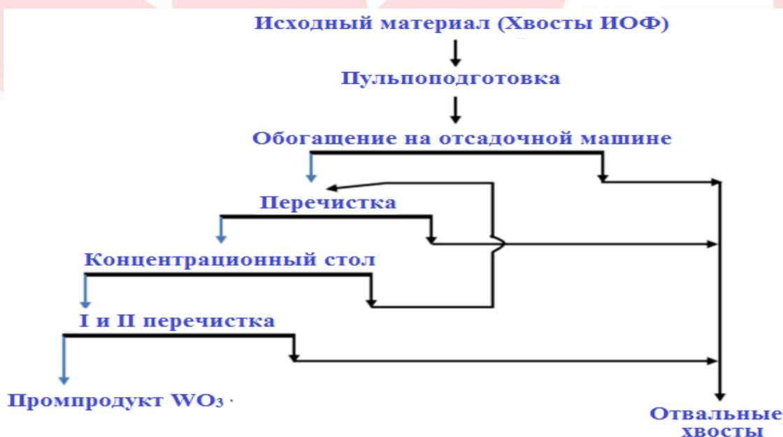
Рис. 1.4 Технологическая схема обогащения лежалых хвостов гравитационным методом
