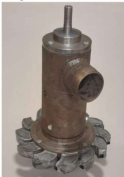
1-расм. Ишлаб чиқилган ички йўналтирувчи конструкцияга эга бўлган гидротурбинанинг тажриба-синов модели.
